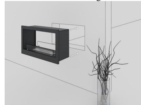
Drücken die Gehäuse von der anderen Seite der Wand gleichmäßig auf den Rahmen, sodass die Löcher in den oberen Teilen des Rahmens und des Gehäuses fluchten. Als nächstes, befestigen den Rahmen mit dem Gehäuse durch diese Löcher mit Schrauben
