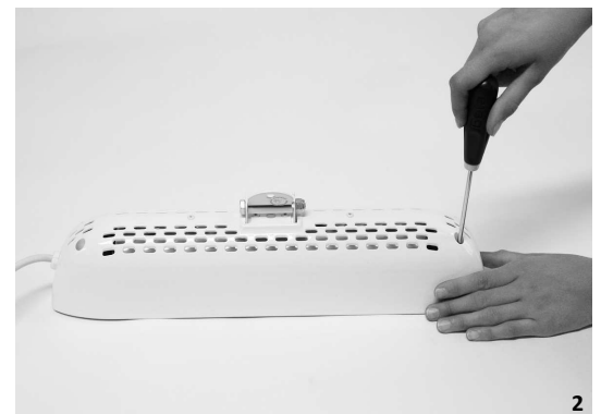
2. DEVISSER LES 4 VIS DE LA PARTIE ARRIERE ET ENLEVER LES DEUX COUVERTURES LATERALES ET LES DEUX PARTIES LATERALES DU REFLECTEUR
