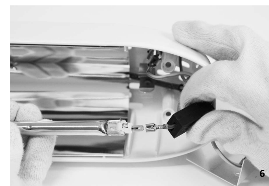
4. DIE BEIDEN SILIKONDICHTUNGEN ABSTREIFEN, DIE DIE LAMPENENDEN BEDECKEN, UND DIE BEIDEN FLACHSTECKER ABZIEHEN. SIND DIE VERWENDETEN DICHTUNGEN VERSCHLISSEN, MÜSSEN SIE ENTFERNT WERDEN, INDEM DIE KABEL IN DER NÄHE DER BEIDEN FLACHSTECKER ABGESCHNITTEN WERDEN.
