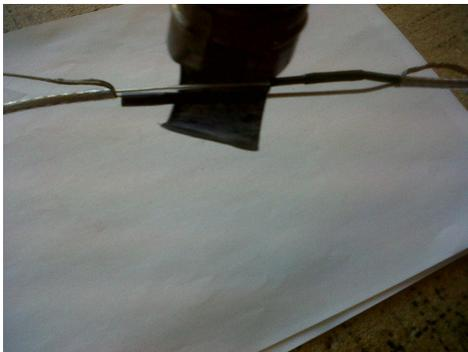
Schritt4: Schrumpfschlauch aufföhnen
