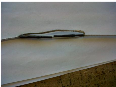
Schritt5: Schutzgeflecht / Erdung mittels unisolierter Pressverbinder 1,5mm<sup>2</sup> verbinden
