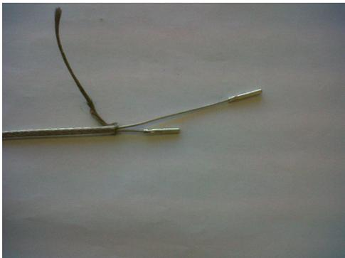
Schritt1: Abisolieren des Außenmantels (ca. 150mm); versetztes Ablängen der Heizlitzen; abisolieren der Heizlitzen (ca. 5mm); aufstecken der Aderendhülsen; aufquetschen der Verbinder 1,0mm<sup>2</sup>
