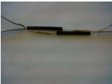
Schritt2: Aufschieben der 2 Schrumpfschlauche 3,2/0,6 Länge: 45mm; versetztes Ablängen der Anschlussleitung / zweiten Heizleitung; anquetschen in die Verbinder
