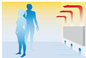
Herkömmliche Heizgeräte erwärmen hauptsächlich die Umgebungsluft, was zu hoher Luftventilation führt. Die warme Luft bleibt an der Decke und die Wärme wird ungleichmäßig abgegeben.
